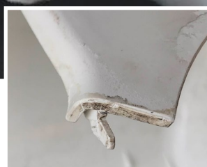
DURANTE LA PULIZIA: Pezzo molto contaminato estratto dallo stampo dopo l'applicazione di Lusin® MC1718
