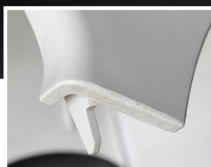
PRIMA DELLA PULIZIA: Contaminazione delle parti a causa dei residui negli stampi
